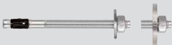
Horgonycsap FAZ II GS (nagy alátéttel) / FAZ II HBS (faszerkezetekhez engedélyezett alátéttel DIN 1052)
